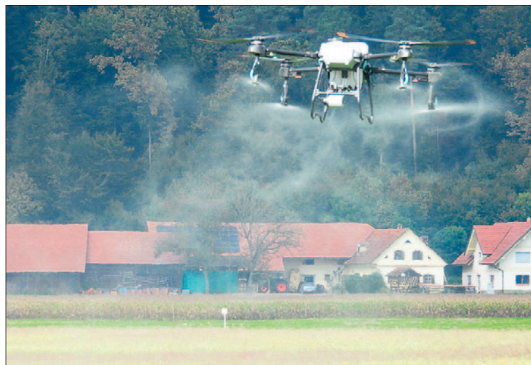
Dron DJI Agras T25 med škropljenjem. Ima 4 centrifugalne šobe.
