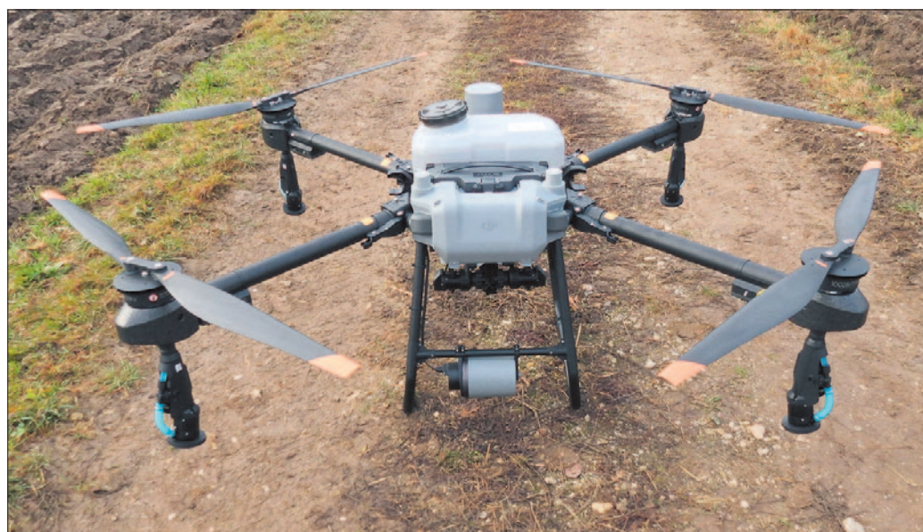
Dron DJI Agras T25 je namenjen za škropljenje ali pa za trosenje trdnih snovi. Za škropljenje je na koncu vsakega kraka centrifugalna šoba.
